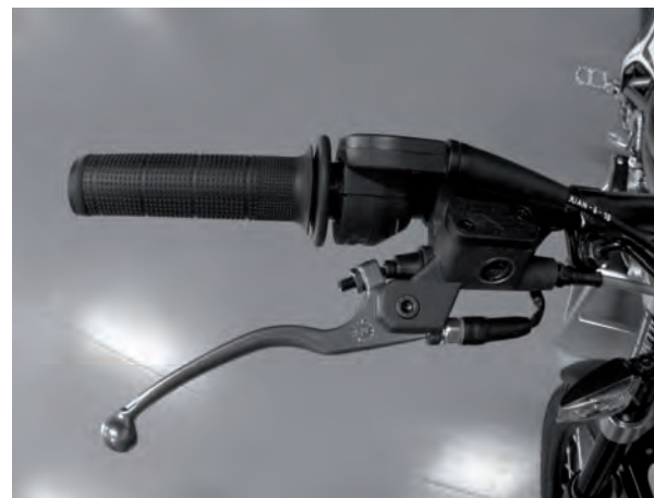
Articulations de poignée d'embrayage et de freins
