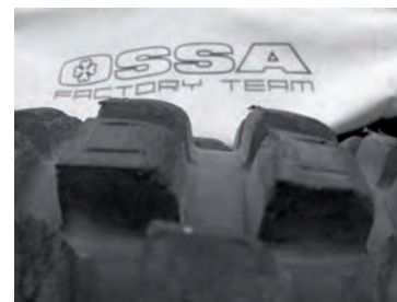
Neumático en mal estado
