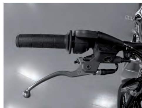
Commande de gaz (poignée droite)
