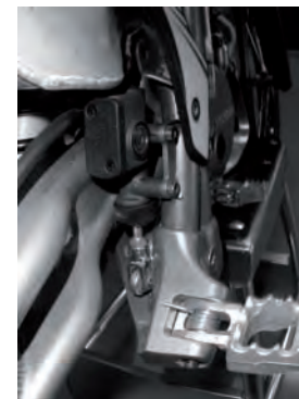
Gelenke und Lager des hinteren Bremspedals
