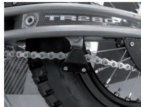
Cadena de transmisión y muelles del tensor
