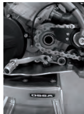
Articulaciones de la palanca de cambio de relaciones
