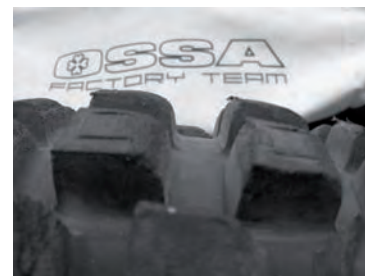
Pneu en mauvais état
